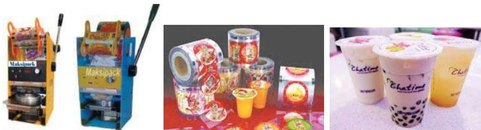
**Gambar 7.4.** Mesin pengemas cup sealer (model M868-Maksipack, D8-Maksipak), plastik penutup cup dan produk hasil cup
